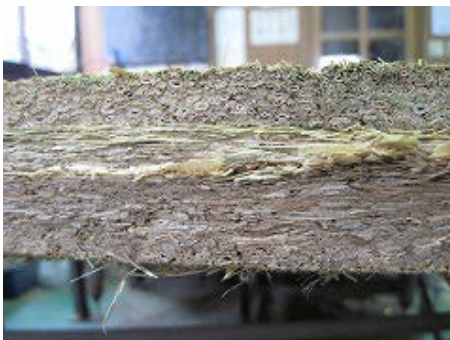
加藤畳店のオリジナル「ヒバ畳床」は、湿気に強く、腐りにくい青森県のヒバを芯材に使った畳の断面。マンションなどの機密性の高い建物に設置してもカビが付きにくい。
